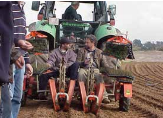
Şekil 28, 29. Kekik için dikim makinesi (sol) ve limon otu fideleri (sağ).
