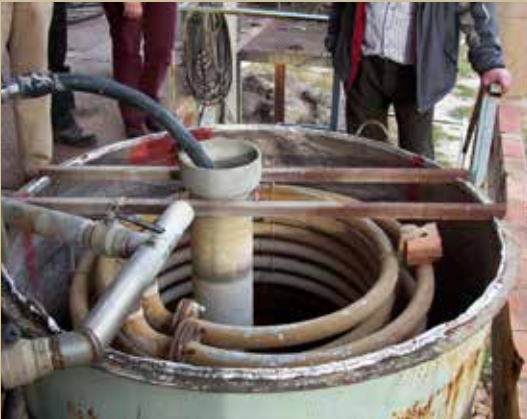
Şekil 57, 58. Soğutucu ve uçucu yağ ayırıcı elemanları.
