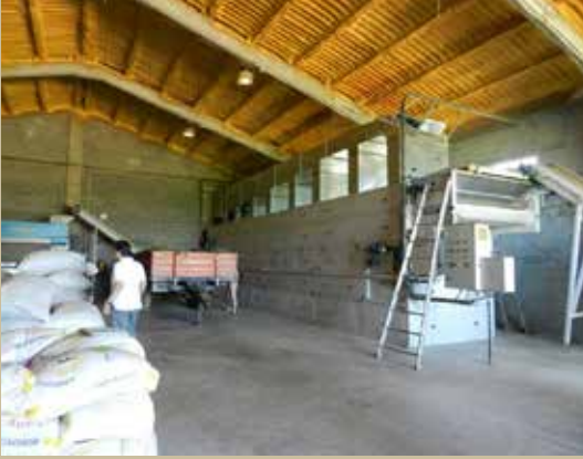
Şekil 47, 48. Taşıyıcı sistem ile sürekli kurutucu.
