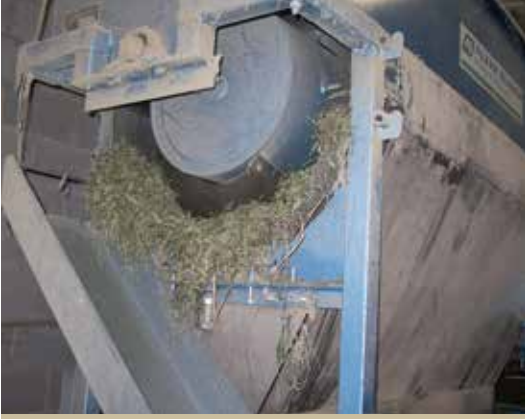
Şekil 49, 50. Kuru bitki malzemeleri elemek için ekipman.
