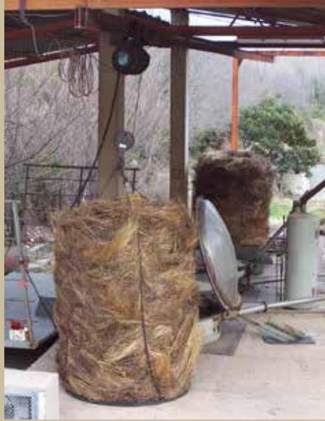
Şekil 55, 56. Buhar damıtma kaynama odası ve boşaltma sistemi.
