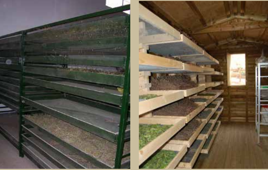
Şekil 42, 43. Delikli raflar kullanılarak doğal kurutma.
