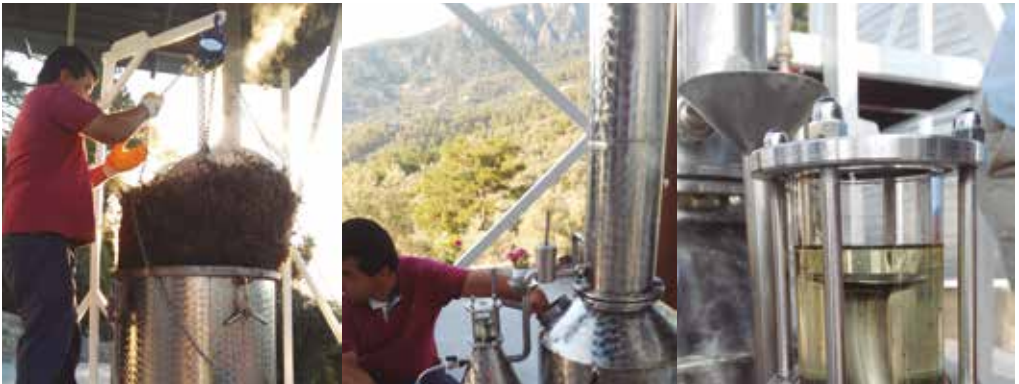
Şekil viii.9. Türkiye'de uçucu yağ elde etmek için lavanta damıtılması
