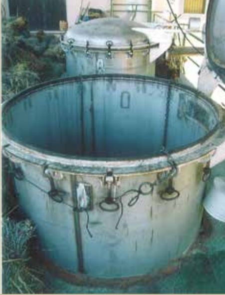
Şekil 55, 56. Buhar damıtma kaynama odası ve boşaltma sistemi.
