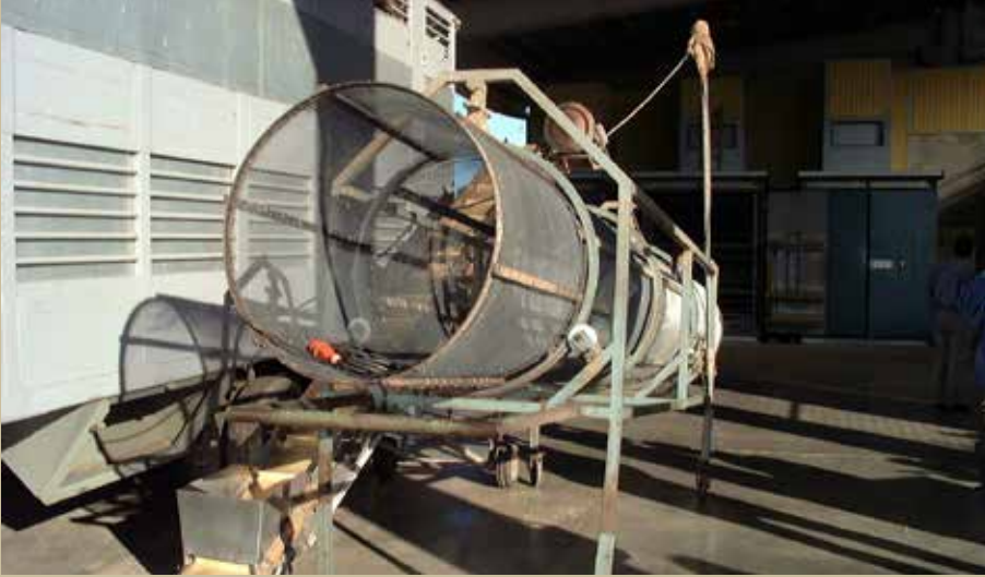
Şekil 41. Bitkileri topraktan arındırmak için farklı elek açıklığına sahip silindir.
