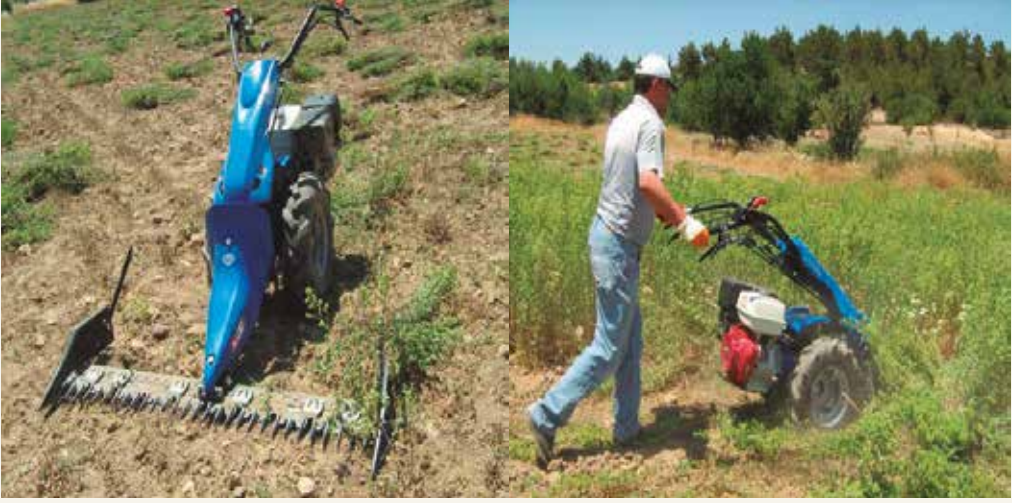
Şekil i.6. Türkiye'de modifiye edilmiş motorlu pullukla Origanum onites 'lerin hasat edilmesi
