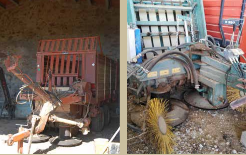
Şekil 39, 40. TAB'ler için kullanılan yem hasat makinesi (sol) ve bitki kenarlarını kaldırmak için bir yem hasat makinesine uyarlanmış fırçalar (sağ).
