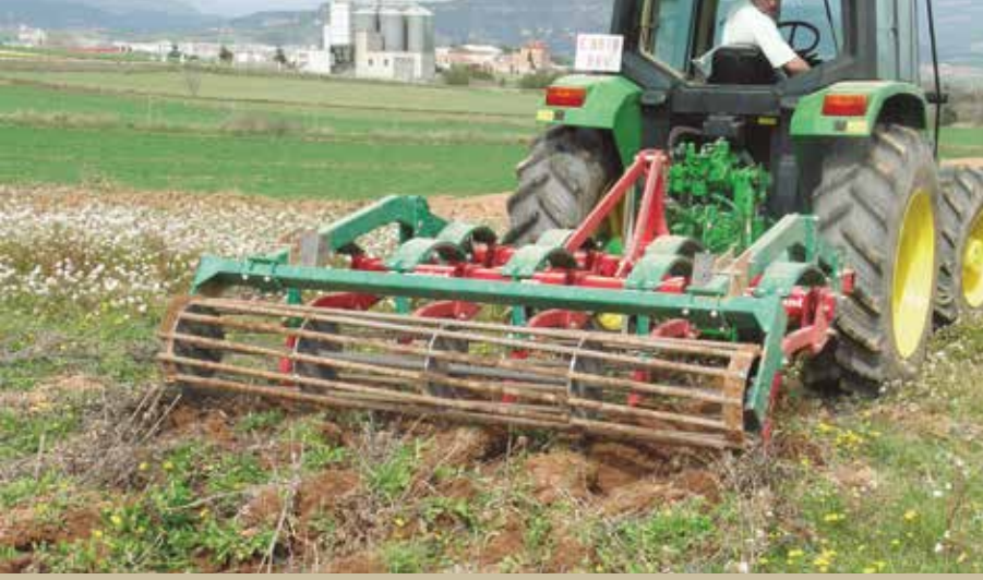
Şekil 63. Echinacea türünün kök hasadı için kullanılan kökten sökücü.
