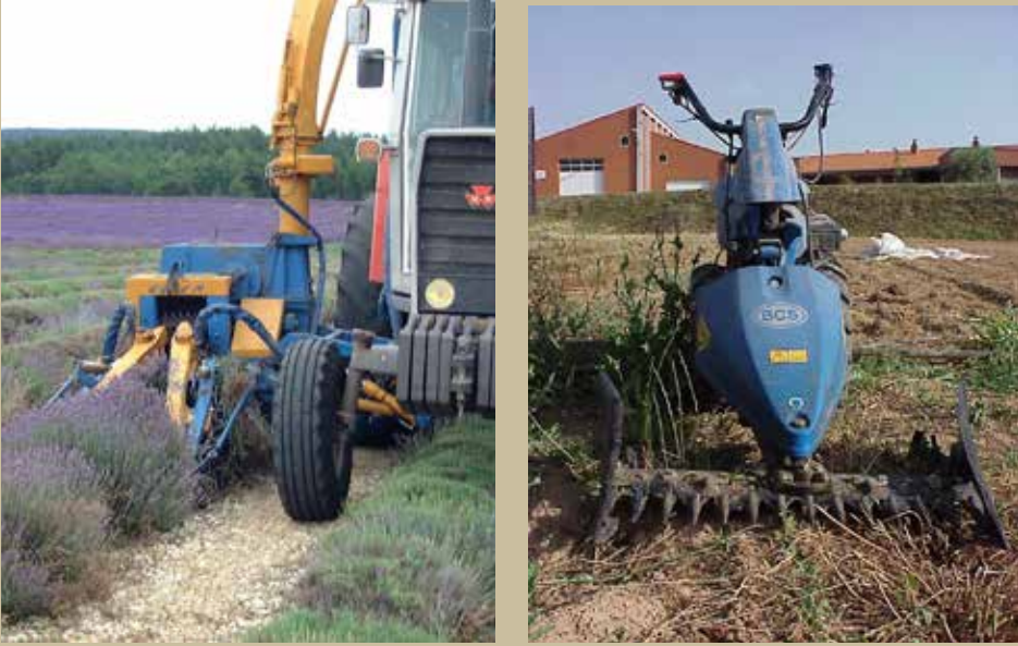
Şekil 37, 38. Lavandula türü için spesifik hasat makinesi (sol) ve motorlu pulluğa eklenmiş kesici çubuk (sağ).
