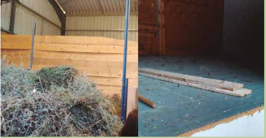
Şekil x.7. Çekmeceli kurutucu (bitki yığınının altından sıcak hava geçer)
